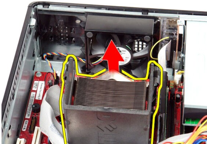
5. Schuif het ontgrendelingslipje onder de middelste kapvergrendeling uit en draai het ontgrendelingslipje omhoog.
